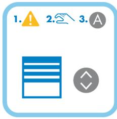
Eine **Sonnenschutzregelung mit Prioritätsauswahl** berechnet unterschiedliche Positionierbefehle mit einer priorisierten Reihenfolge, so dass Beschädigung der Sonnenschutzeinrichtung (Wind, mechanische Kollision) vermieden wird, aber trotzdem manuelle Benutzereingriffe gewährt werden.
