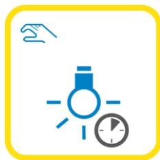
Die **Lichtregelung mit Ausschaltzeitverzögerung** wird mit einem Schalter manuell ein- und ausgeschaltet. Zusätzlich wird das Licht mindestens einmal täglich automatisch ausgeschaltet.
