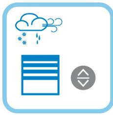
Der **Witterungsschutz resp. Kollisionsschutz** (z.B. Innenjalousie bei offenem Fenster) verhindert die Beschädigung der Sonnenschutzeinrichtung. Eine Wetterstation kann Wind, Regen oder Vereisung detektieren und die Sonnenschutzeinrichtung mit der Prioritätssteuerung in die geeignete Position fahren.
